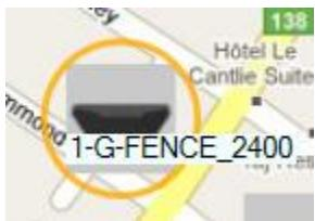
Lors d'une perte de communication (COMMUNICATION\_LOST ou SMARTBRIDGE\_LOST), un cercle orange apparaitra durant cette perte. Il disparaîtra automatiquement lorsque la communication sera rétablie.
