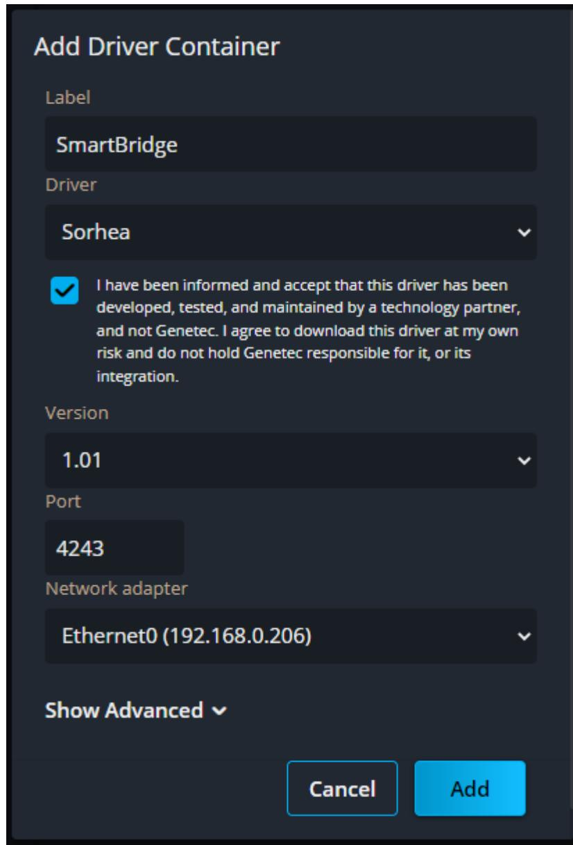
Sous label, entrer un nom, par exemple « SmartBridge ». Sous driver, choisir « Sorhea ». Cocher la case pour accepter les conditions. Sous version, sélectionner la plus récente. Laisser le port 4243 par défaut et choisir la carte réseau du serveur Genetec. Enfin, cliquer sur « Add ».
