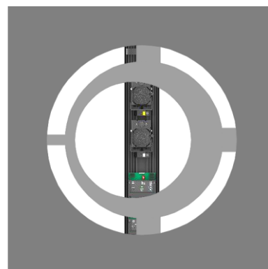
Mauvaise visée optique : La mire et/ou la colonne sont décentrées
